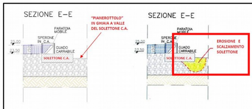
Figura 3: Confronto per la sez. E-E dell'attività erosiva rilevata a seguito degli eventi eccezionali susseguiti .
