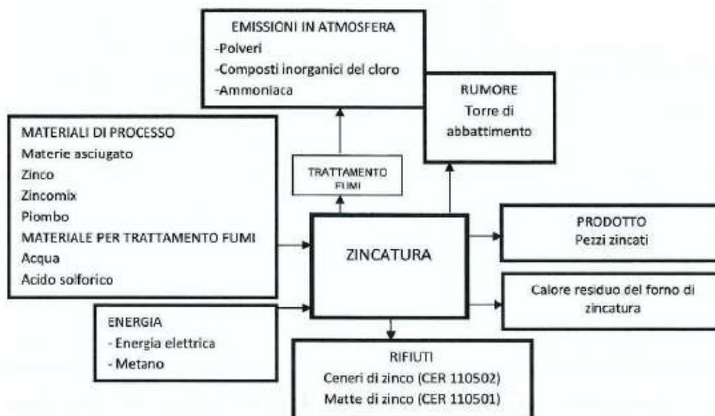
Il materiale viene **immerso nella vasca** (riscaldata mediante bruciatori a gas e mantenuta ad una temperatura di 450 °C) contenente **zinco fuso e piombo** tenuti in agitazione attraverso l'immissione di gas.
