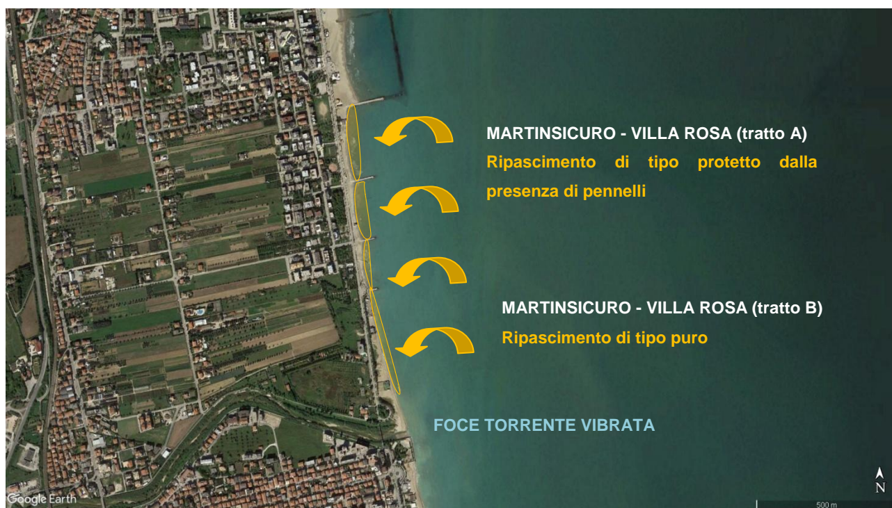
Figura 6 - Schematizzazione tipo dell'intervento Martinsicuro Villa Rosa
