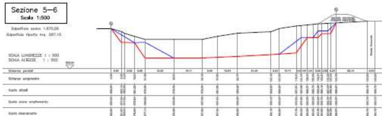
Figura 3 – Esempio sezioni di scavo (per approfondimenti si rimanda alla tav. 5 allegata allo SPA)
