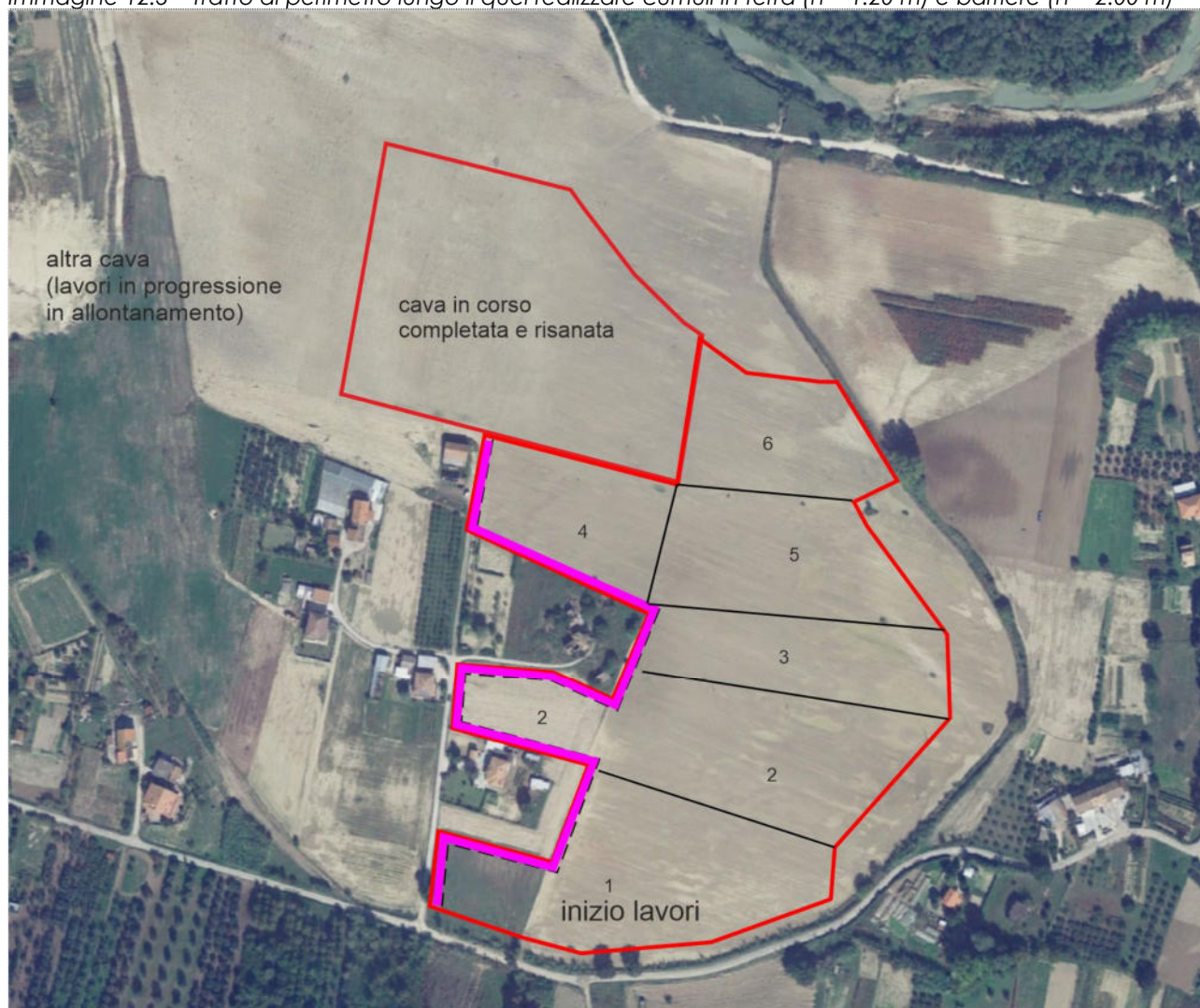
Immagine 12.3 – Tratto di perimetro lungo il quel realizzare cumuli in terra ( h = 1.20 m) e barriere ( h = 2.00 m)
