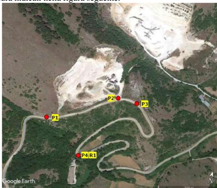
Il recettore R1 risulta essere ubicato ad una distanza di circa 170 metri dal confine del sito. La misurazione presso il recettore R1 (punto di misura P4) è stata effettuata ad un metro dalla facciata dell'edificio. Ai valori
