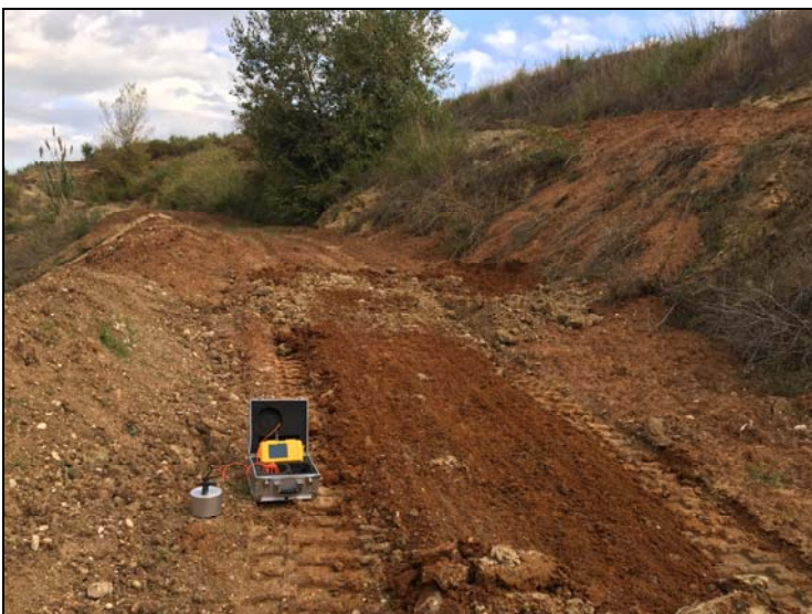
Figura 6.4: – Ubicazione dell'indagine sismica HVSr
