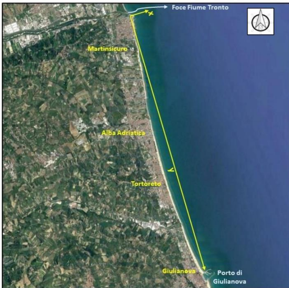
Figura 4.3: schema del sistema di riferimento della griglia di calcolo.
