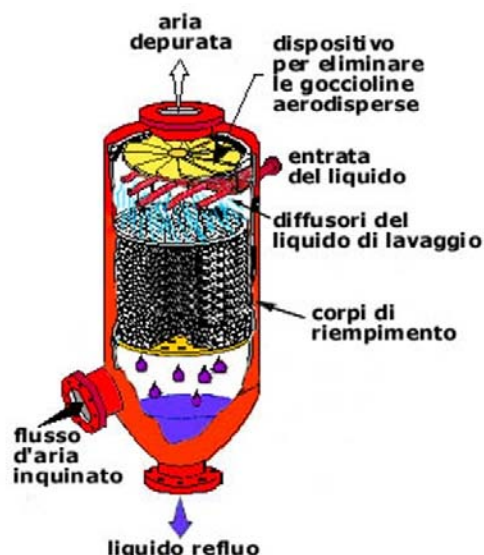
Figura 12 - Schema di funzionamento di abbattitore ad umido Scrubber in controcorrente
