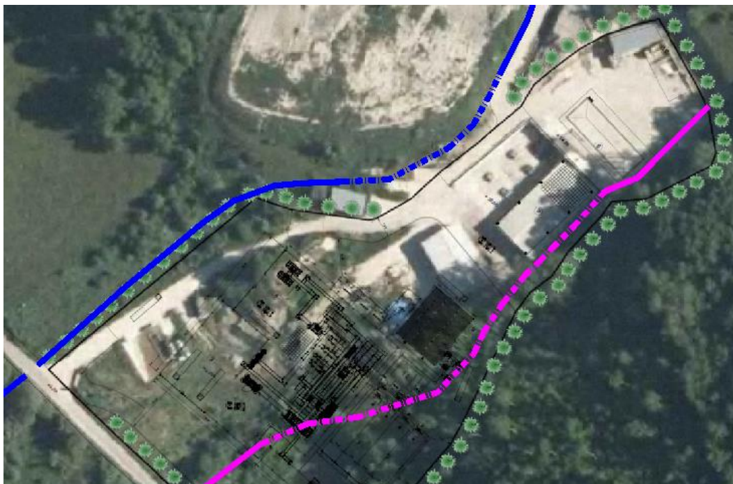
Figura 3.1– Opere di drenaggio esistenti
