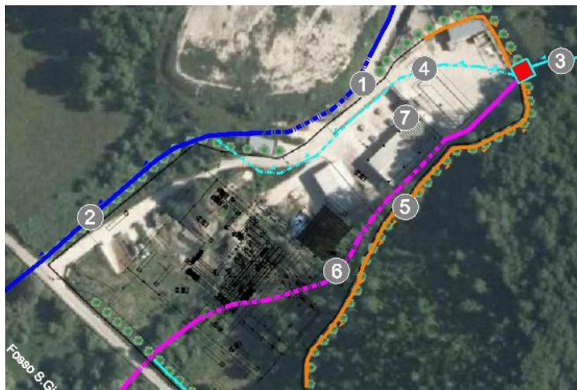
Fig. 5: ubicazione delle opere di drenaggi
