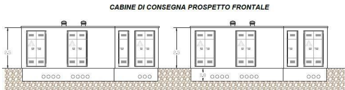
Fig. 11 - prospetto cabine di consegna
