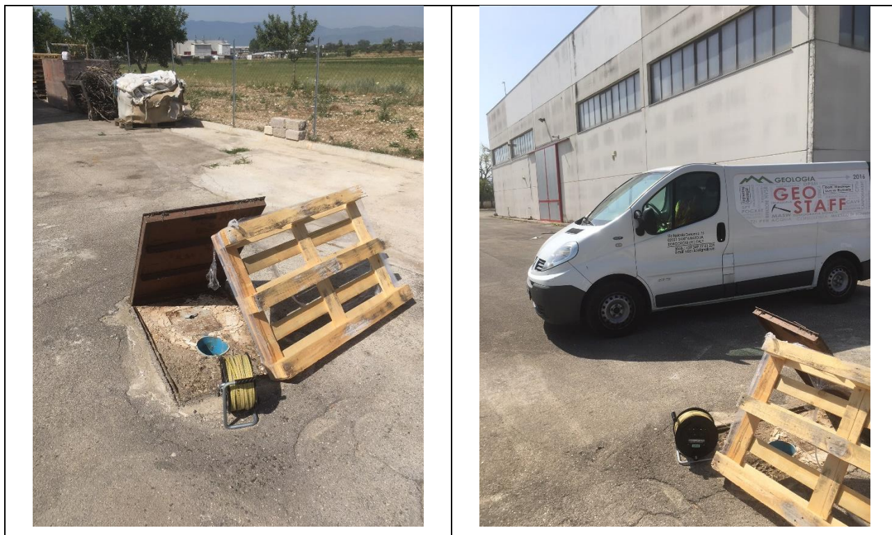
Figura 9: Immagine riferita alla misurazione del livello piezometrico all'interno del pozzo di proprietà della committenza.
