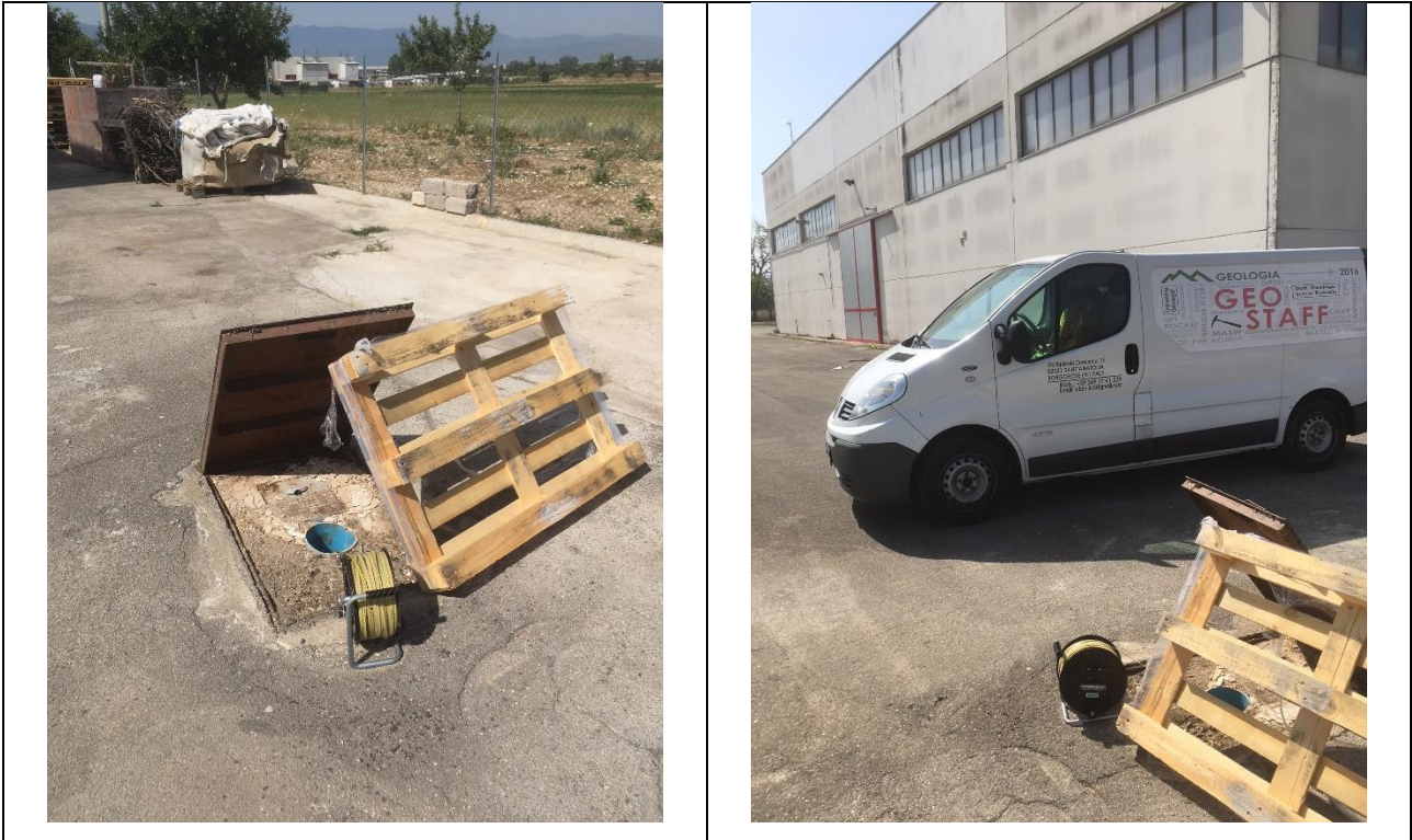
Figura 9: Immagine riferita alla misurazione del livello piezometrico all'interno del pozzo denominato 1 nella cartografia sopra "Denuncia di avvenuta scoperta delle acque sotterranee" prot. 3343 del 30/01/2006 attualmente non utilizzato"
