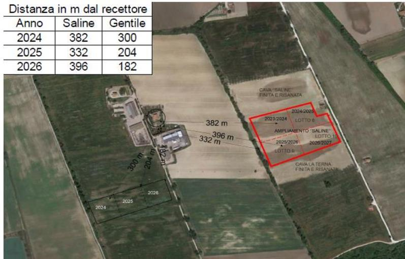
In entrambe le cave che saranno attive tra il 2024 e il 2026 si configura la presenza contemporanea di: un escavatore: 97 dB, una pala caricatrice: 101 dB e un autocarro: 80 dB
