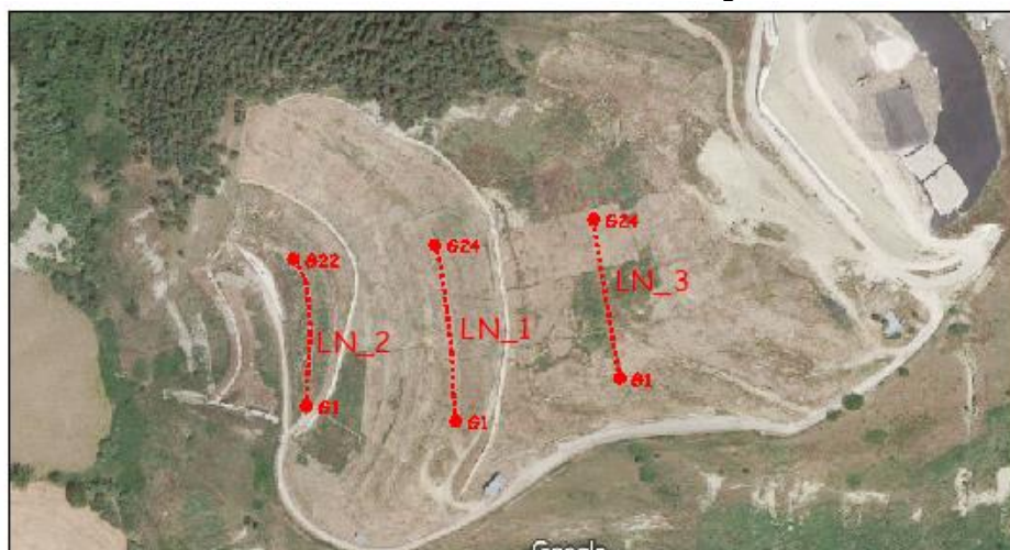
Ubicazione stendimenti sismici eseguiti
