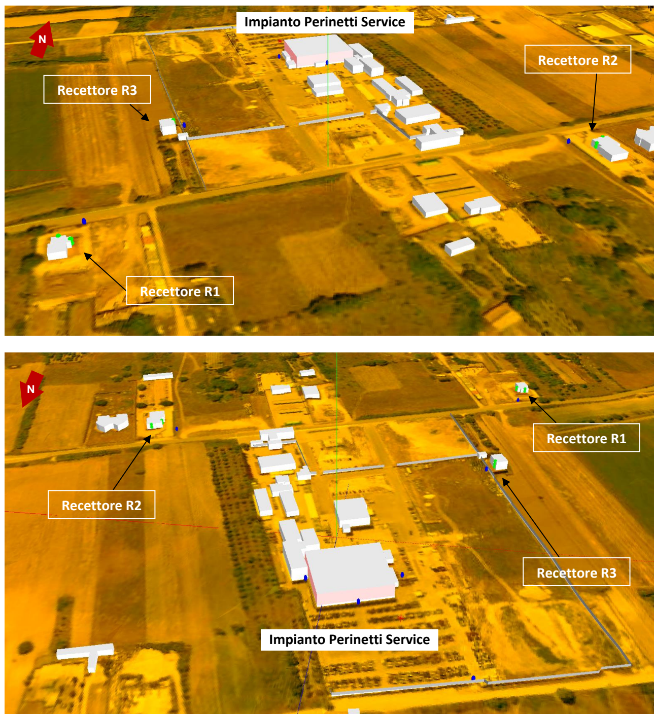
Figura 6 - Schematizzazione del modello 3D dello stato di fatto per l'analisi dei livelli sui singoli ricettori (sfere verdi) e i punti di controllo per la verifica del modello (sfere blu).
