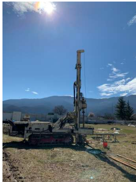
Figura 13 – Sonda perforatrice tipo “CMV 900 D1”
