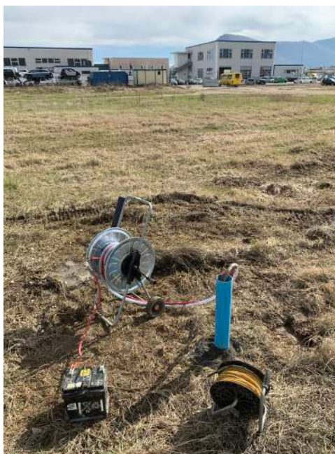
Figura 12. Fase di spurgo di un piezometro con elettropompa sommersa.
