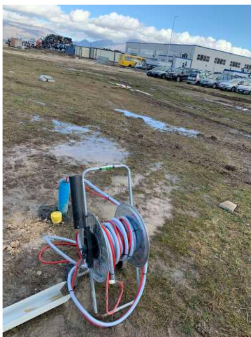
Figura 14 – Attività di sviluppo tramite elettropompa sommersa di un piezometro.
