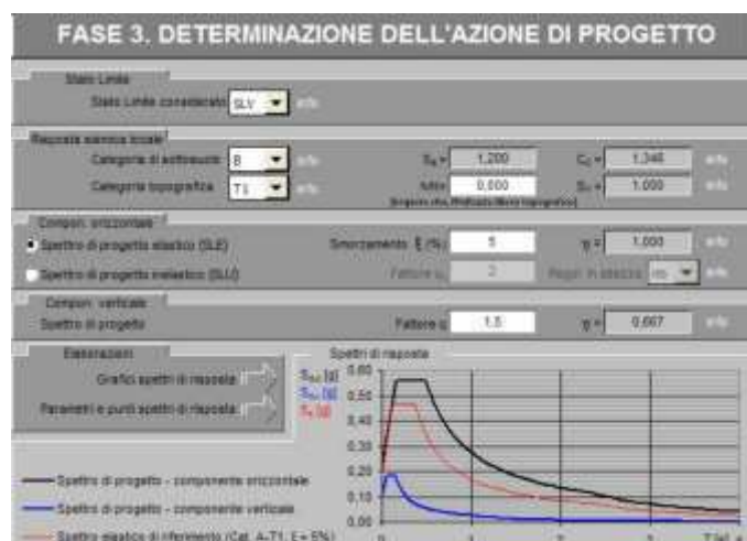
Figura 3.7: parametri e grafici per la determinazione dell'azione di progetto da software Spettri NTC
