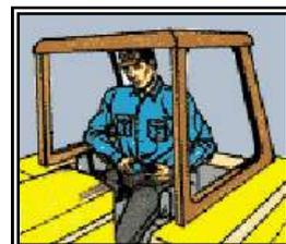
L'operatore é quindi protetto dalla struttura speciale della cabina contro il pericolo di schiacciamento, dovuto al ribaltamento del mezzo e contro la caduta di materiale. Nel caso del ribaltamento é necessario però che l'operatore sia allacciato con le cinture di sicurezza. In tal modo non verrà proiettato all'esterno e non correrà il rischio di rimanere schiacciato dal mezzo.
