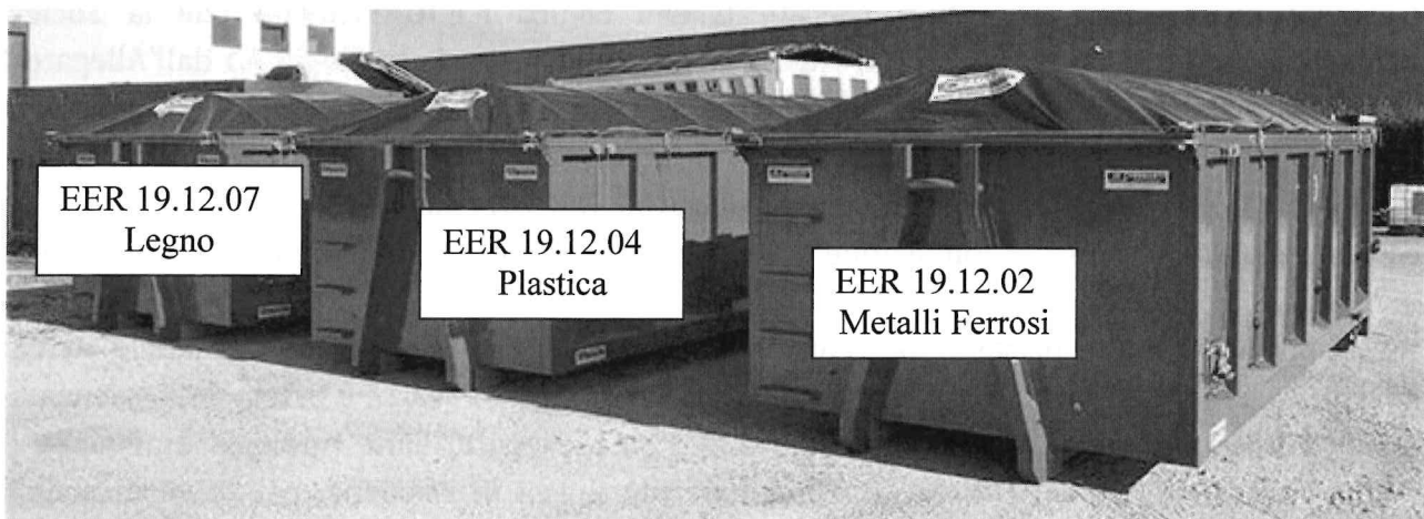
Esempio, cassoni scarrabili, per il deposito dei residui di lavorazione
