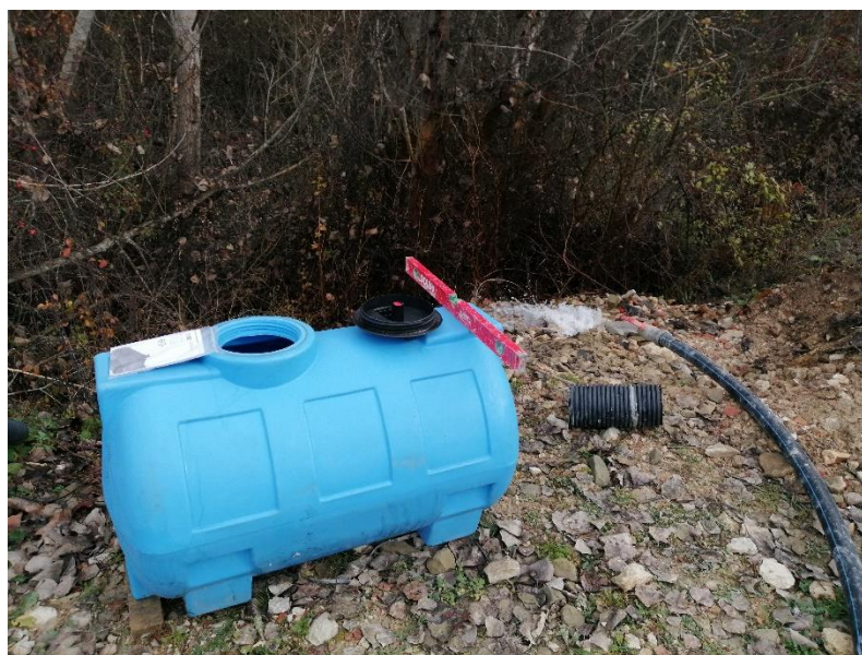
Figura 7 – Foto de recipiente utilizzato per a misura della portata in litri al secondo.
