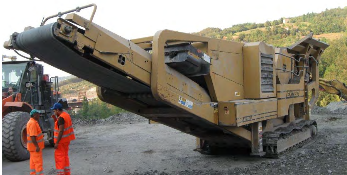
Vista dell'impianto mobile C-12 + e del nastro trasportatore principale
