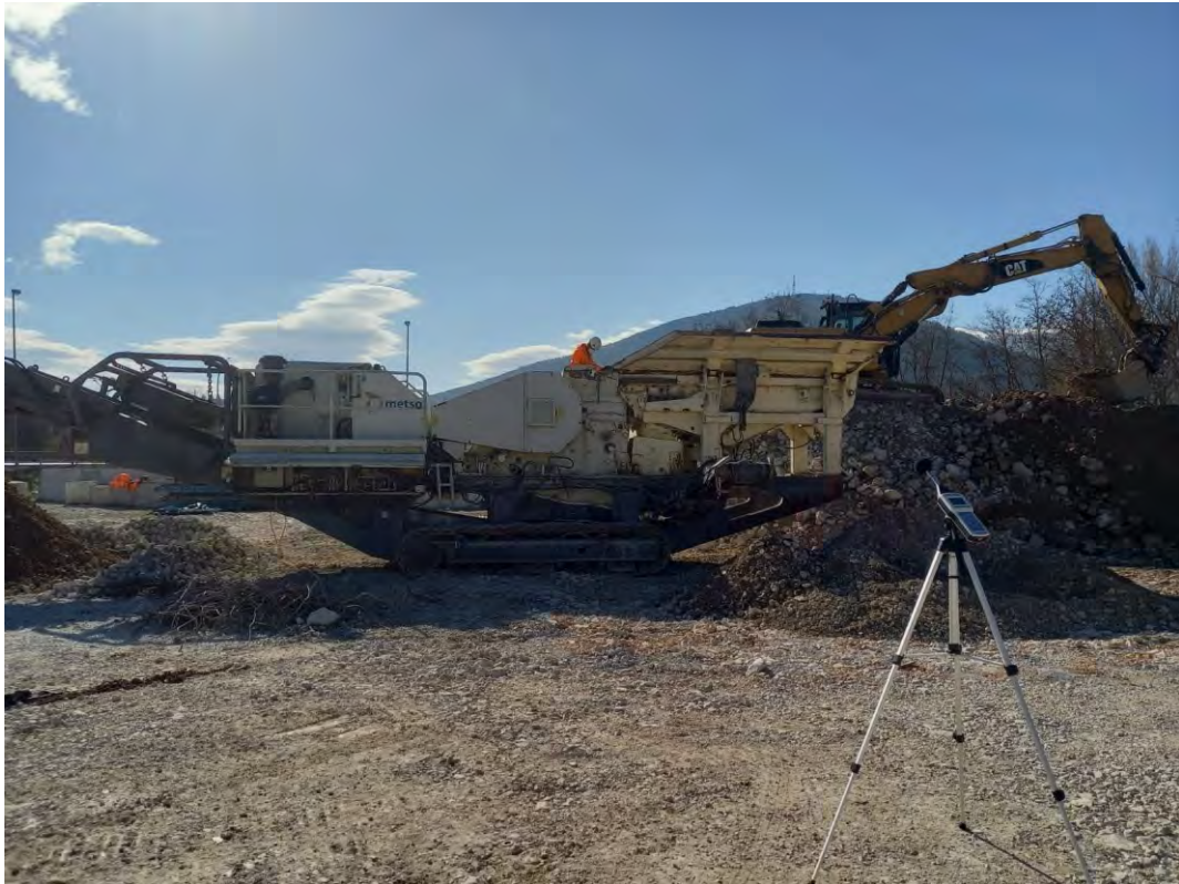
Foto 1 – Sorgente frantoio mobile ed escavatore per carico
