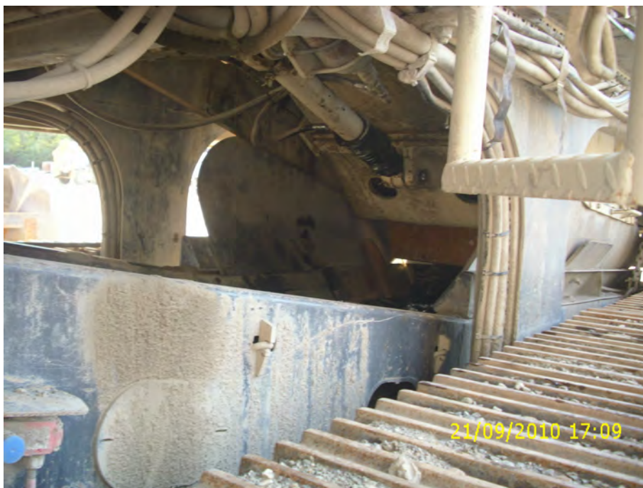
Foto 8: Sistema di contenimento delle polveri - ugelli
