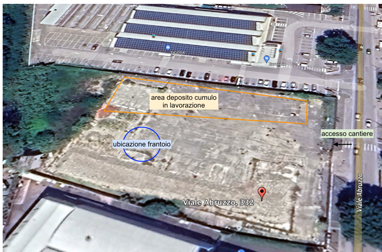
Fig.7 – Rappresentazione layout dell'area di cantiere / campagna mobile di recupero
