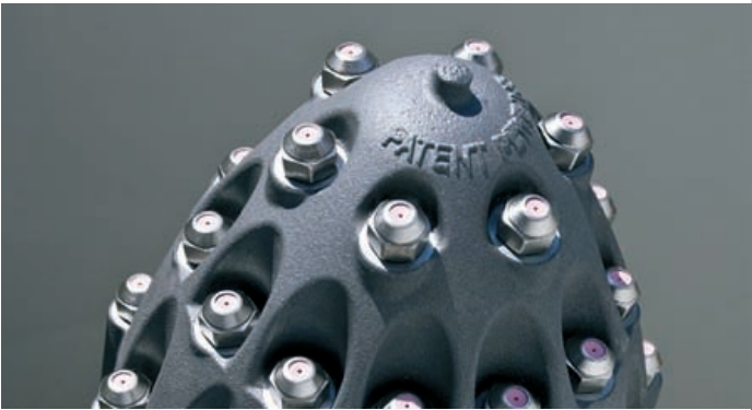
Figura 1 – Esempio di testa porta ugelli, completa di 12 + 18 ugelli (totale 30 pezzi) nel mod. MEDIUM o 30 + 14 (totale 44 pezzi) nel mod. BIG, prodotti in ceramica e brevettati. Uno dei molteplici vantaggi è che produce una nebulizzazione molto fine e parecchio resistente al vento
