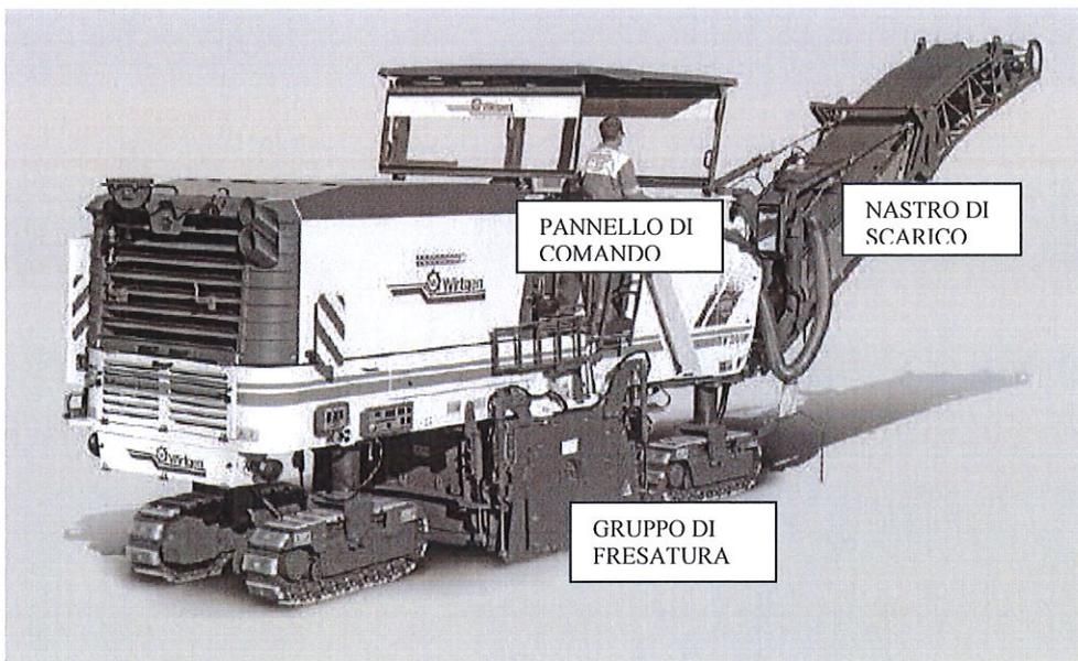
Fig. n. 2 – WIRTGEN W200 – parti principali
