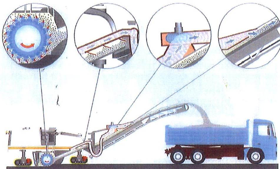
*Foto n. 4 – WIRTGEN W200 Fi - VACUUM CUTTING SYSTEM*
