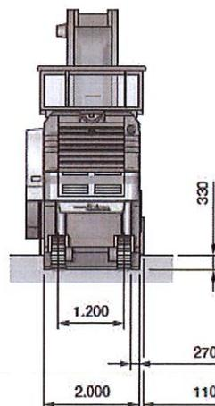
Fig. n. 4 – WIRTGEN W200 Fi – vista posteriore
