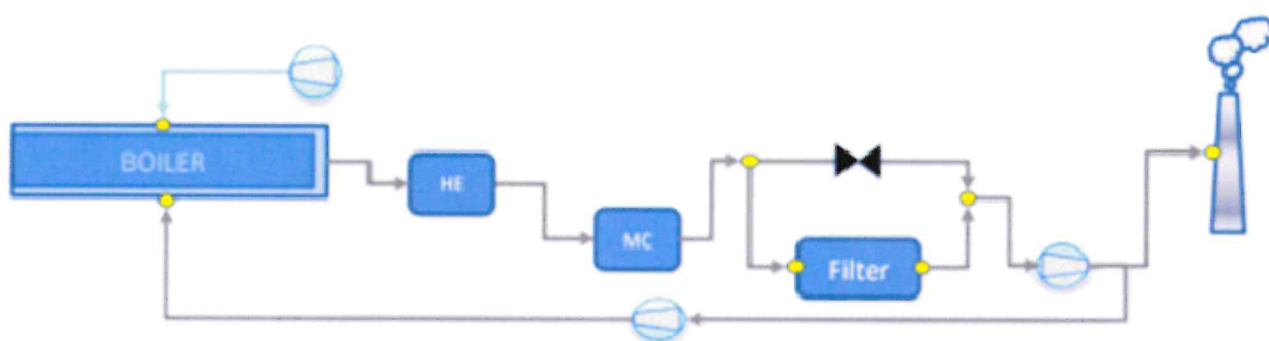
Fig. 4 - Flow-sheet semplificato dell'impianto di co-incenerimento con recupero energetico
