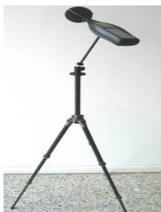
Figg. 2 e 3 Fonometro utilizzato per i rilievi fissato su treppiede e provvisto di cuffia antivento
