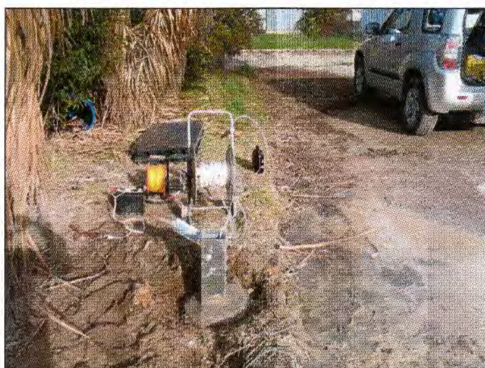
Foto 5 – Spurgo e campionamento del piezometro Pz1 con pompa low flow.
