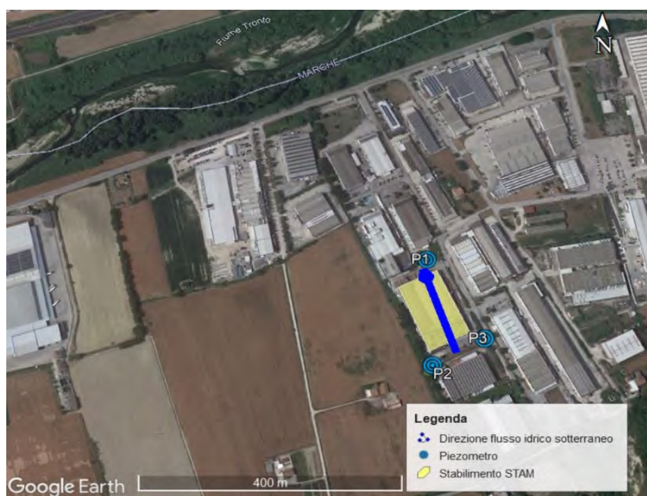
Figura 7: Direzione del flusso idrico sotterraneo
