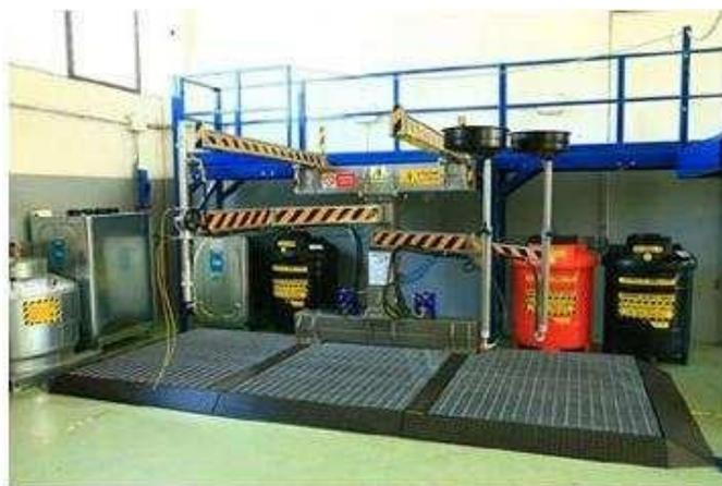
Una volta posizionato e sollevato l'autoveicolo per mezzo di sistema idraulico, si dà inizio alla fase di smontaggio manuale eseguita con comuni utensili da lavoro, e con specifiche attrezzature tutti i componenti classificabili quali
