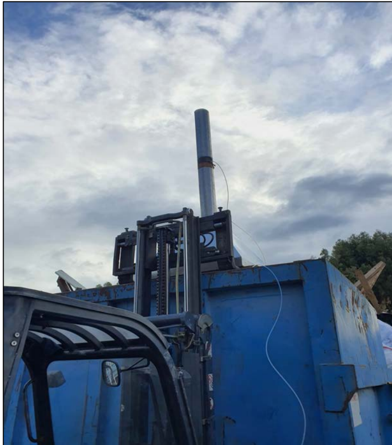
Figura 10: Cappa mobile utilizzata per la caratterizzazione della sorgente di emissioni odorigene.
