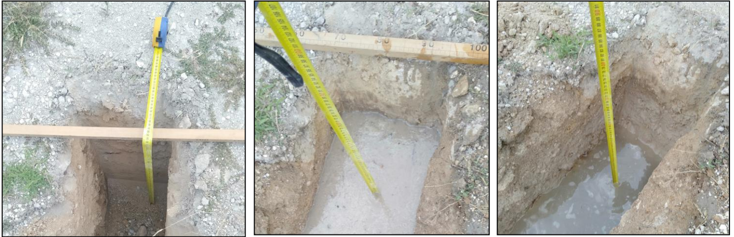
Fig.2 Fasi esecutive del pozzetto esplorativo e prova di permeabilità
