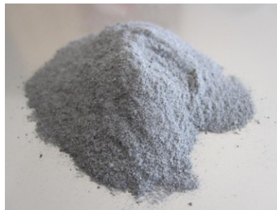
La polvere di silicio che si ottiene alla fine del processo.
