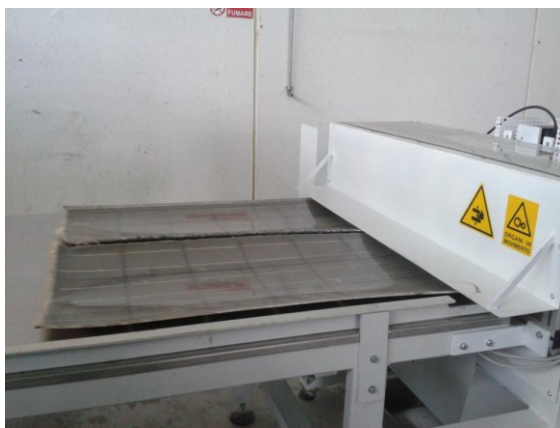
3 All'inizio del processo di smaltimento, il modulo viene tagliato longitudinalmente in due parti
