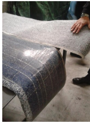
4 Il tappetino formato da celle, materiale plastico e rame in uscita dalla devetratrice
