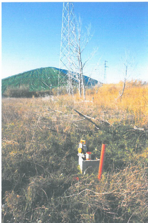
DISCARICA PER RIFIUTI SPECIALI INERTI (II CATEGORIA TIPO A) VILLA CARMINE - MONTESILVANO (PE) DOCUMENTAZIONE FOTOGRAFICA DEI TERMINALI PIEZOMETRICI E DEL BOCCAPOZZO
