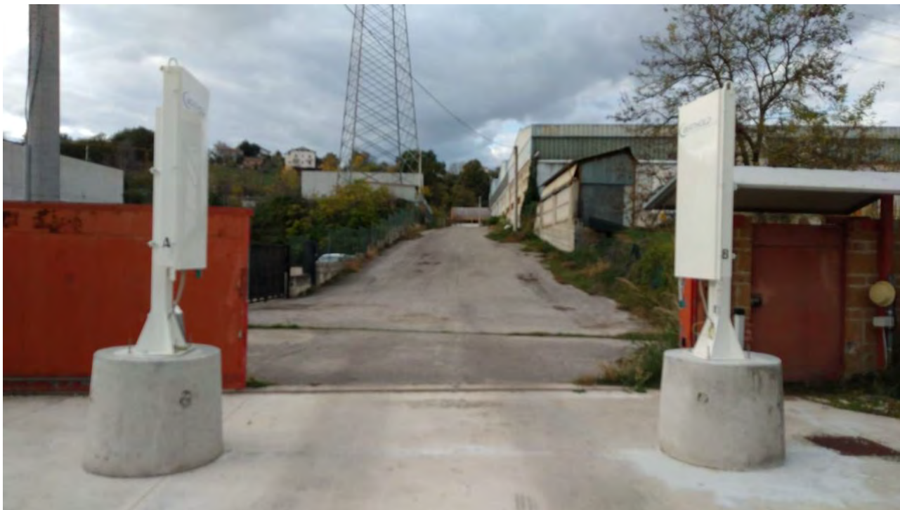
Figura 23 Pannelli installati per la sorveglianza radiometrica
