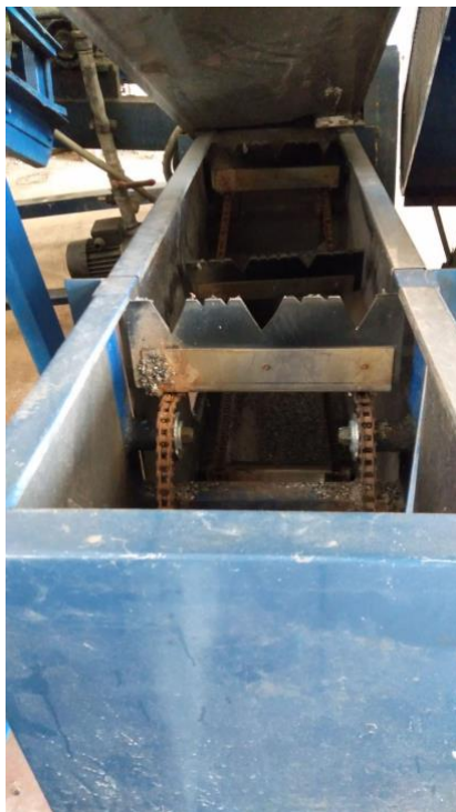
Figura 29 Particolare del luogo di raccolta delle guaine triturate
