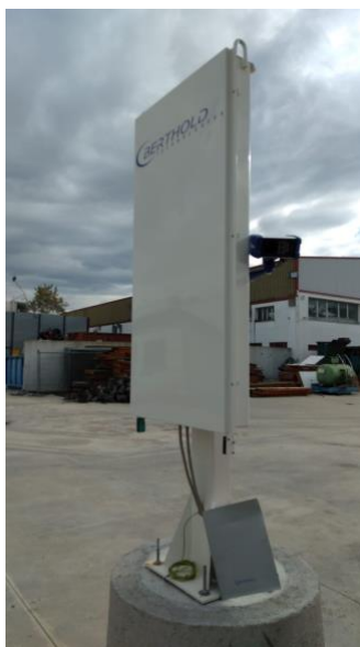
Figura 22 Pannelli installati per la sorveglianza radiometrica
