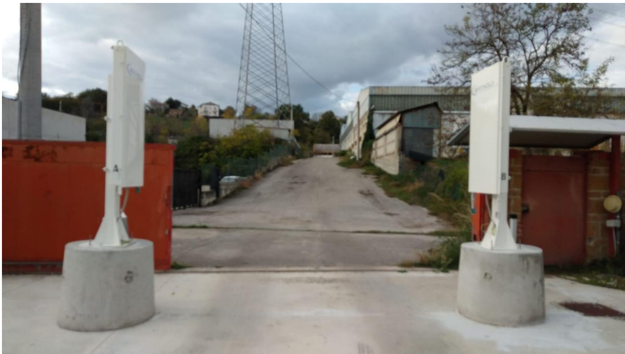
Figura 23 Pannelli installati per la sorveglianza radiometrica
