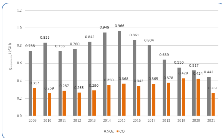
Figura 73 – Fattore di emissione della centrale di cogenerazione
