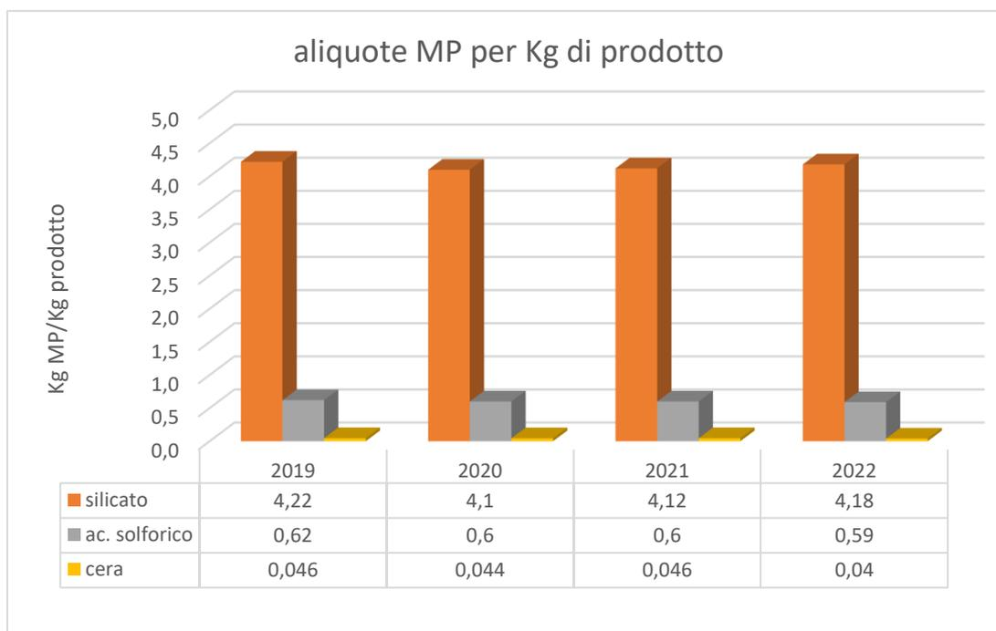
A seguito di continui miglioramenti del controllo del processo chimico di reazione, le aliquote di silicato di sodio e acido solforico hanno raggiunto un valore ottimale.
