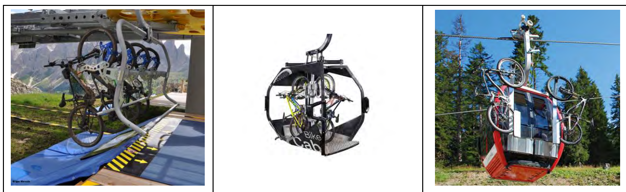
Figura 89 Esempi di integrazione fra mezzi a fune e ciclovie [Fonti: leitner.com, doppelmayr.com]
