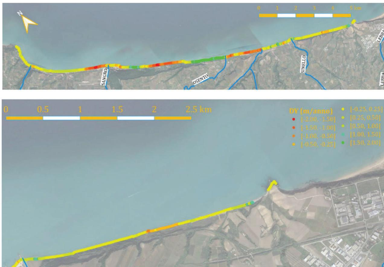
Fig. 2.4 Analisi della tendenza evolutiva recente del litorale. Evoluzione della linea di riva nel periodo 1997-2018. Dettaglio tra la foce del Sinello e punta Penna (fonte AnCoRA – Analisi di dettaglio monografica UF09)
