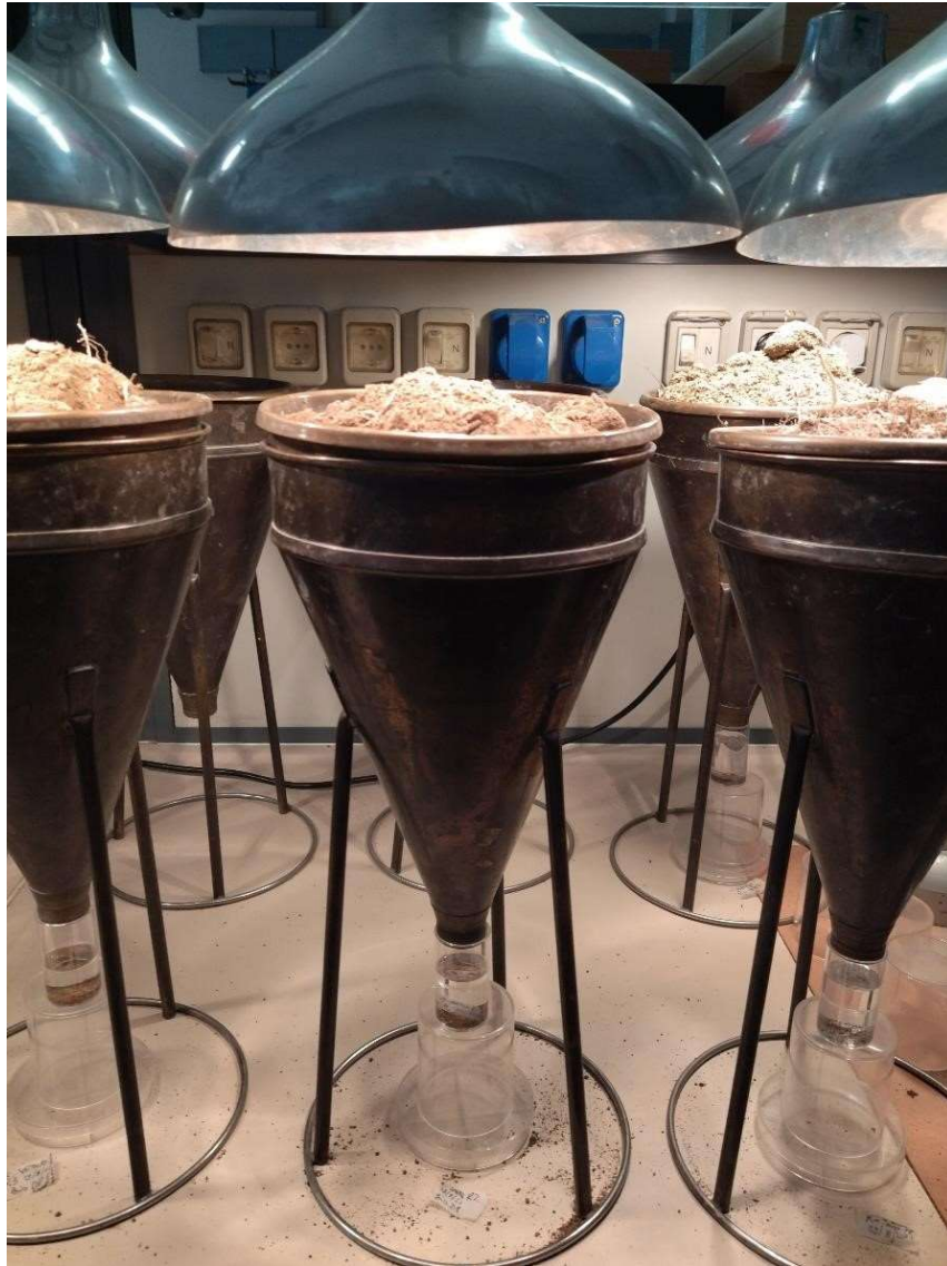
Figura 35. Estrattori Berlese-Tullgren. Il campione di suolo viene posto su una griglia metallica (maglia di 2 mm) montata sull'estrattore, che consiste in un imbuto sormontato da una lampada ad incandescenza.
