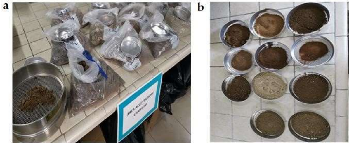
Fig.20. (a) Area accettazione campioni. I campioni sono stati lasciati aperti all'aria per 1 giorno e setacciati; (b) I campioni sono stati setacciati a 0,5 mm per tutte le future analisi.
